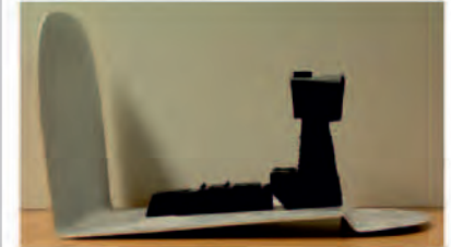
Die Abbildung zeigt die Cockpitsäule sowie die Cockpitkonsole auf der Bodenplatte des Modells BO-105
