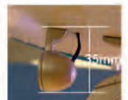
Die Abbildungen zeigen einen funktionsfähig montierten Scheinwerfer am Modell Big-Lifter Typ 214 mit 1,8m Rotordurchmesser.
