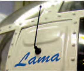
Antenne mit Aufnahmesockel schwarz lackiert mit Gewindebefestigung
