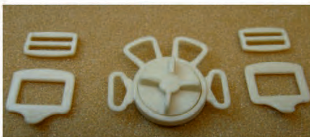
Sicherheitsgurtschloß mit Gurtführungen für Modelle im Maßstab 1:4 Maße: Gurtschloß innen 21mm Gurtführung 19 x 15mm
