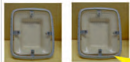
Turbinenschutzgitter mit Lufteinlässe für Lama fertig montiert Rahmen und Gitter silber lackiert
