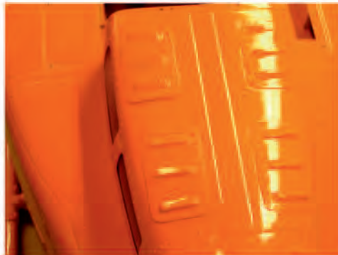
Die Abb. zeigt silber lackierte und benietete Lufthutzen auf dem Modell 214- Big-Lifter
