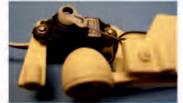
Die Abbildungen zeigen einen funktionsfähig aufgebauten ausfahrbaren Landescheinwerfer
