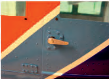
Die Abbildung zeigt ein montiertes Türschloßschild bei unserem Modell UH 1 D Typ 205
