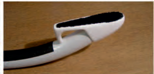
Beim Modell Big-Lifter oder anderen Modellen kann der Kufenschuh durch tiefere Ausfräsung dem Kufenrohr angepaßt werden.
