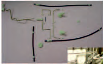
Kabel und Leitungssatz (4)
