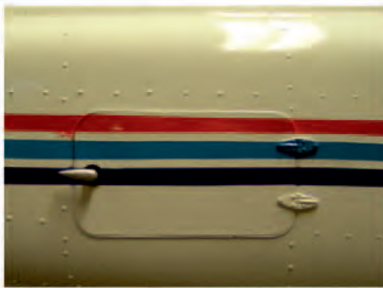
Aufstiegsklappen und Revisionsdeckel aus 0,3mm Alu gefräst.
