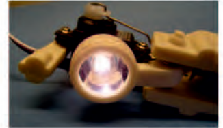
Die Abbildungen zeigen einen funktionsfähig aufgebauten ausfahrbaren Landescheinwerfer
